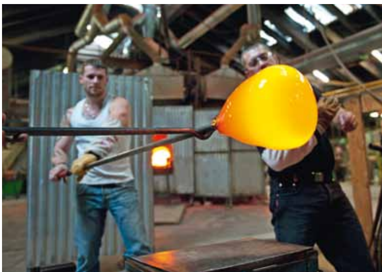
Das geschmolzene Kristall wird aus einem der Öfen im Atelier der Heissglasverarbeitung gezogen.
