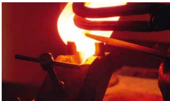
Die Entstehung des Klassikers von Wellendorff: Im ersten Schritt wird das 18-karätige Feingold geschmolzen.
