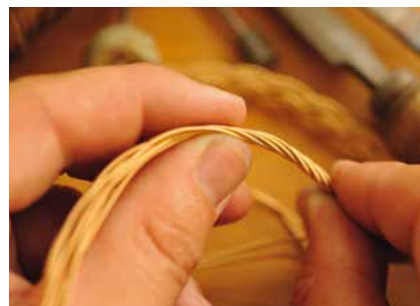
Im letzten Schritt werden die einzelnen Golddrähte miteinander verflochten, um das klassische Kordel-design zu erhalten.
